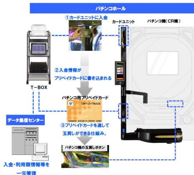
図1 パチンコ用プリペイドカードシステムの仕組み
