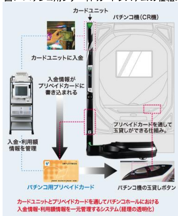
図1 パチンコ用プリペイドカードシステムの仕組み
